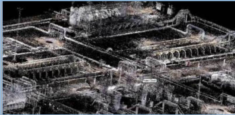
Трехмерное облако точек объекта, снятое с нескольких станций
