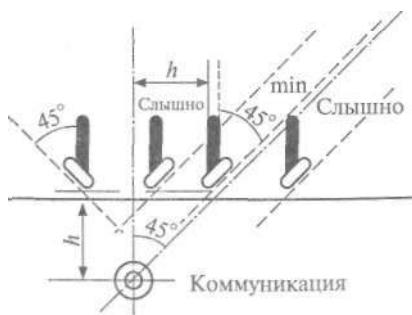
Рис. 17.4. Схема определения высотного местоположения подземной коммуникации при помощи прибора поиска
