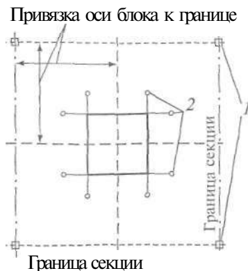
Рис. 21.5. Схема разбивки осей блока плотины:
