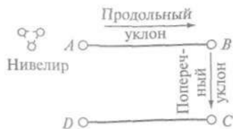
Рис. 13.5. Схема построения в натуре линий проектных уклонов
