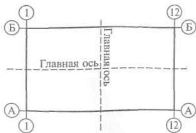
Рис. 13.1. Главные оси здания
