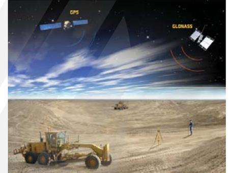
**mmGPS технология** – для позиционирования рабочего органа машины используются спутниковые измерения совместно со специальными лазерными определениями. Технология mmGPS - это уникальное запатентованное решение Topcon. Смотрите дополнительную информацию на странице 28 данного каталога.
