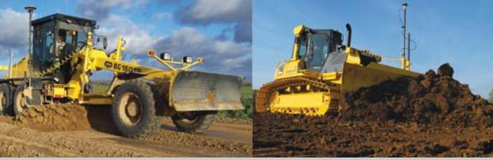
**ГНСС технология** – для позиционирования рабочего органа машины используются измерения по спутниковым сигналам систем ГЛОНАСС и GPS. Для осуществления оперативного контроля спутниковая система работает в режиме реального времени (RTK).
