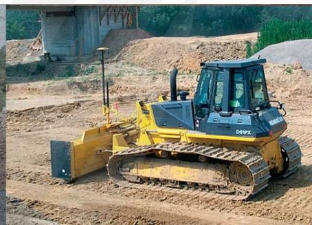
К особенностям 3D ГНСС системы Торсон относится возможность работы с двумя спутниковыми приемниками GPS/ГЛОНАСС, интуитивно понятное программное обеспечение и четкая согласованная работа гидравлики. Система ГНСС легко изменяется на лазерную 2D систему или 3D LPS систему, а также легко модернизируется до Торсон mmGPS.
